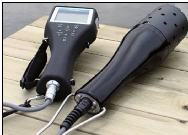
Figura V.1-37 - Sonda multiparamétrica U 5000G utilizada para a medição dos parâmetros in situ .
